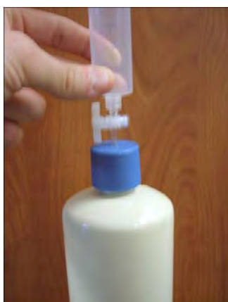
Figura 6 - Riempimento della siringa con il gas utilizzando la valvola blu di trasferimento
