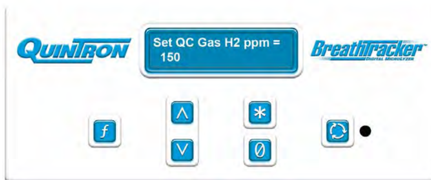
Figura 9 - Aggiustare il valore di calibrazione dell' H_2
