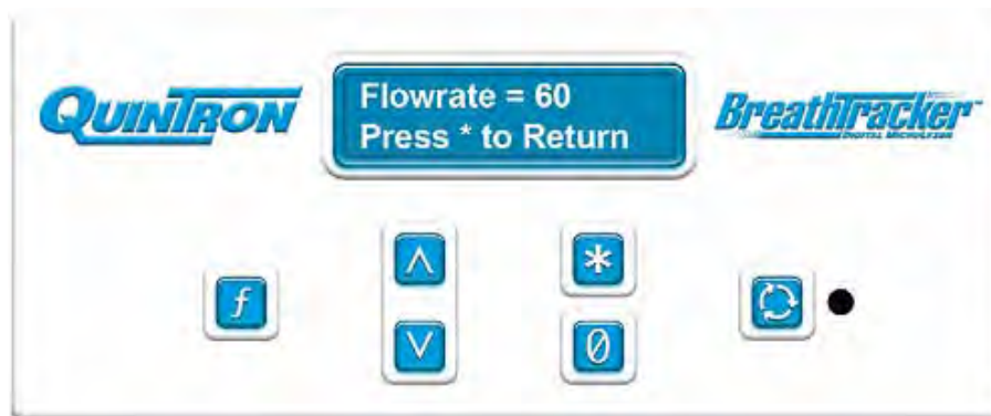
Figura 20 - Display della velocità di flusso.
