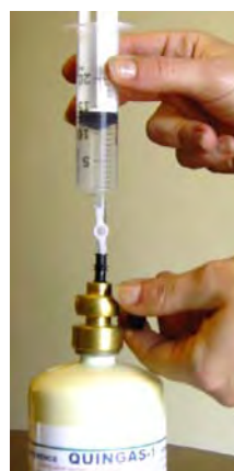
Figura 6 - Riempimento della siringa con il gas utilizzando la valvola blu di trasferimento
