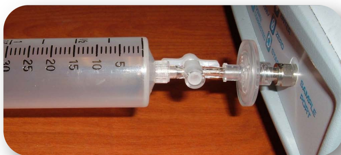
Figura 13- Iniezione del gas di calibrazione
